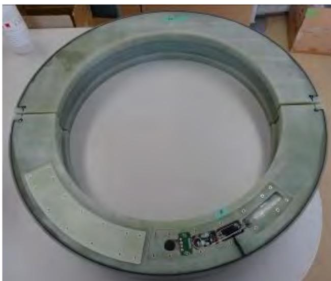
■リングアンテナ式誘導給電式温度テレメータ
