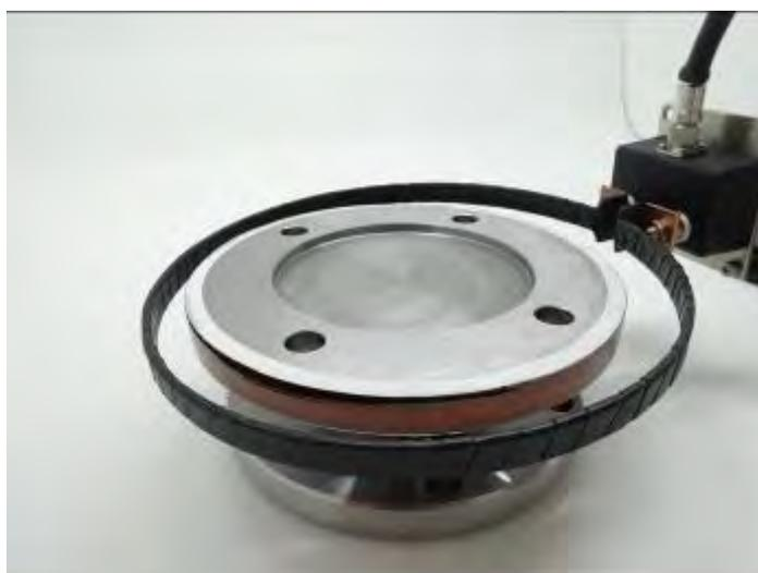
■リングアンテナ式誘導給電装置—送電コイル
