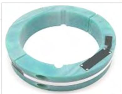
■誘導給電式ひずみテレメータ 送信機・送電コイル
